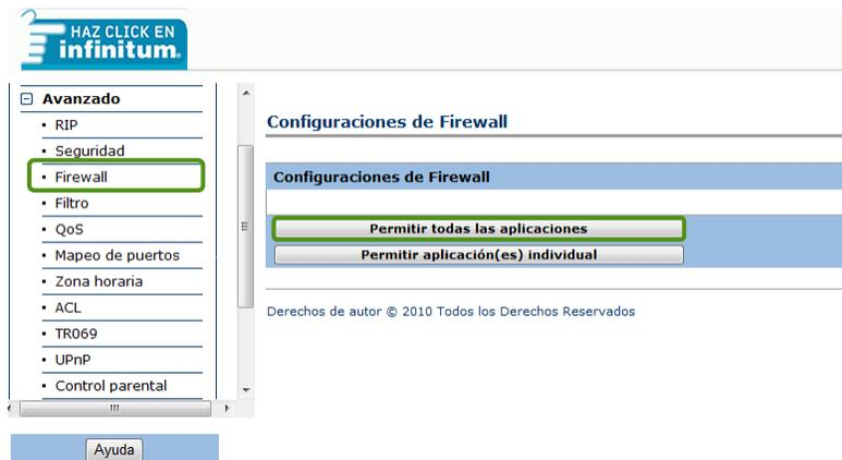
Figura 5.1-2. Configuración de Firewall en Modem.
